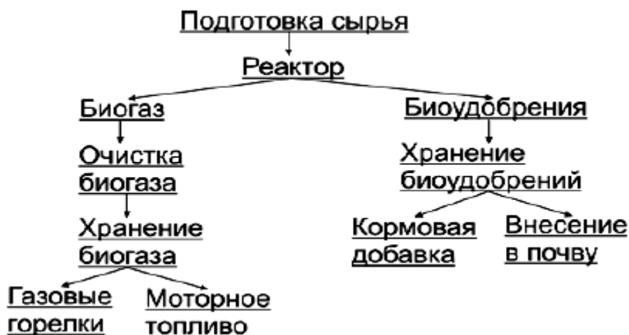
Рисунок 2 – Схема переработки органических отходов на биогазовых установках
